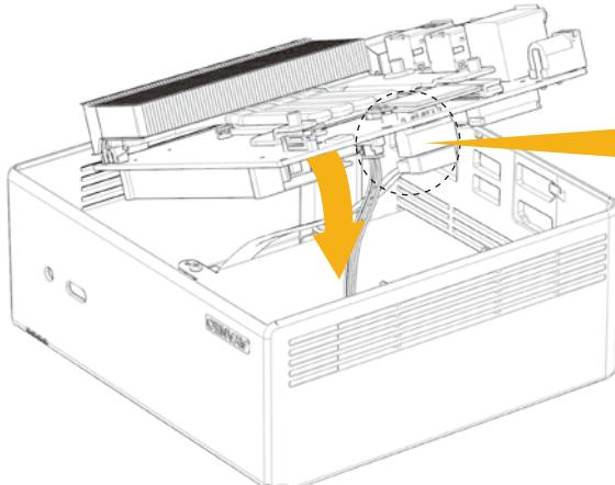
4 • 连接主板与 2.5 英寸硬盘 SATA 线缆的数据与供电端子。
