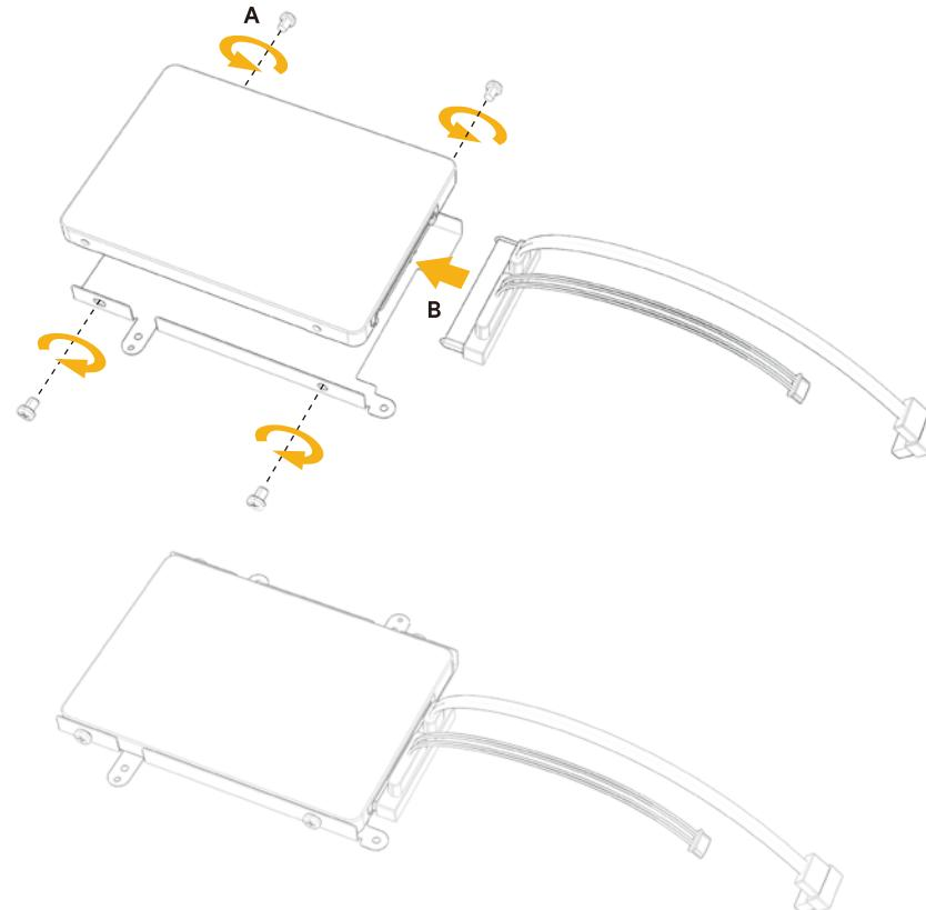
2 • 将装好支架及线缆的 2.5 英寸硬盘总成装进 AYANEO Mini PC。
